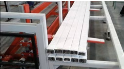
Palletizer for bars and pack formation. Pallettizzatore per barre e formazione pacco.
