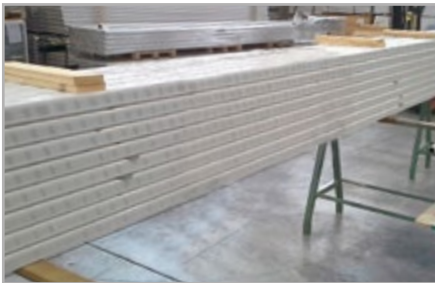
Product package formed by palletizer. Pacco prodotti formato da pallettizzatore.
