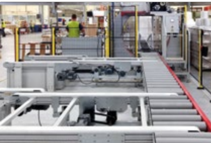
Automatic motorized unloader with lateral motorized belt storage. Scarico laterale automatico a cinghie con magazzino laterale motorizzato.
