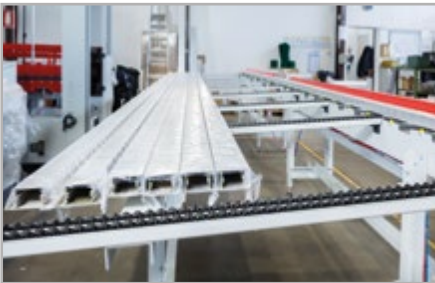
Idle lateral storage. Magazzino laterale di accumulo folle.
