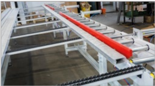
Automatic lateral pusher pneumatically actuated. Spintore laterale automatico ad azionamento pneumatico.
